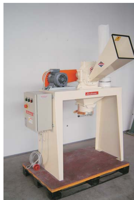
Opzione tramoggia di alimentazione per corpi lunghi e foglie
